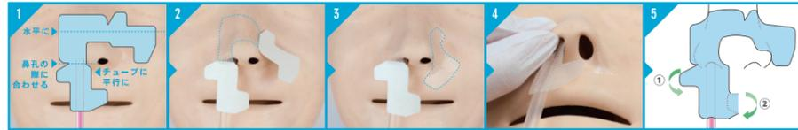
貼る前に一辺の両端を持ち、貼る位置に一度水平に合わせて確認します（もう一辺はチューブと平行になるようにします）
